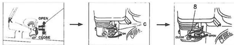
Palivový kohout na nádrži, 'OPEN' (otevřeno)
