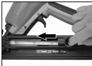
Obr. 11, nastavenie posúvania klincov
